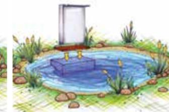
Der Waterfall 30 wird nun auf dieser geraden Platte montiert: Dazu mit rostfreien Edelstahlschrauben die zwei seitlichen Befestigungsglaschen fixieren.
