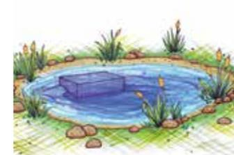
Als erstes schaffen Sie eine gerade und feste Fläche – eine solide Basis z.B. aus Beton, die als Sockel dient.
